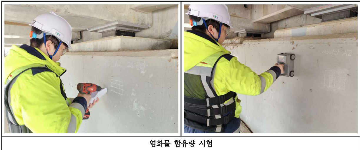
【사진 3.38】 염화물 함유량 시험 현장사진
